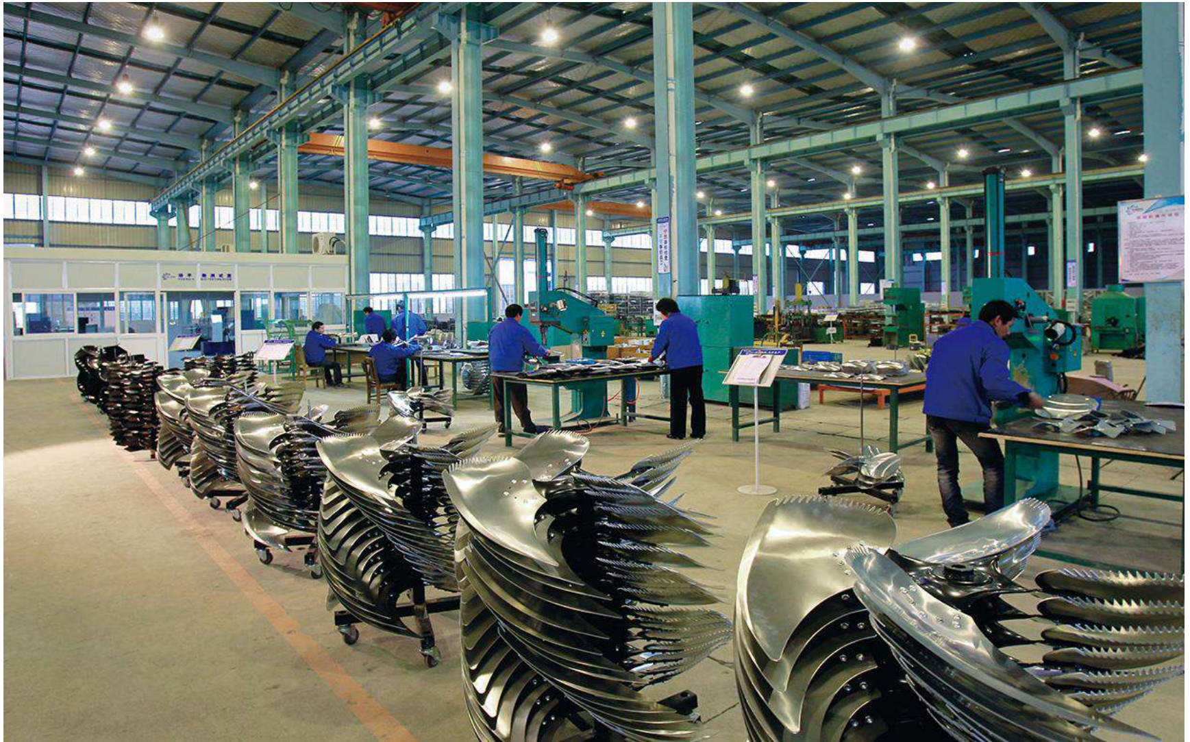
Fan blade: Aluminum magnesium alloy
